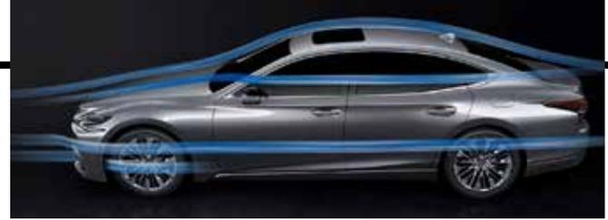
hinter den Hinterreifen haben unterstützende Wirkung, die Verwirbelungen reduzieren und Luftwiderstandswerte optimieren.
