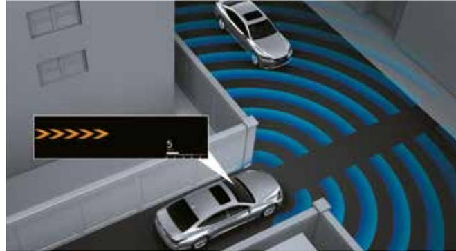
kreuzendem Verkehr verhindern. Es verwendet ein nach vorn gerichtetes Radar, das dem Fahrer die Richtung anzeigt, aus der sich ein Fahrzeug nähert. Die Warnhinweise werden auf dem Head-up-Display dargestellt. Sollte der LS trotz des kreuzenden Verkehrs weiterfahren, ertönt zusammen mit einem Warnhinweis auf dem Multiinformationsdisplay ein Warnton.
