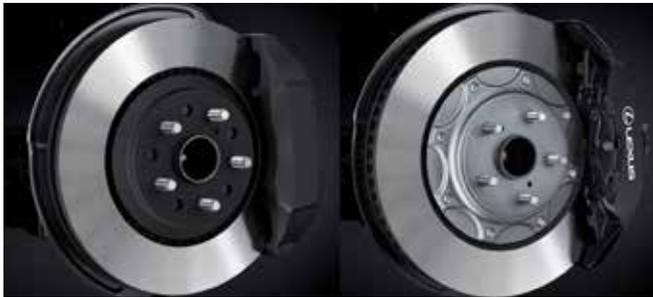
Das System verfügt über innenbelüftete Bremsscheiben im Format 357 x 34 mm vorn und 335 x 25 mm hinten. Vorn gibt es Vierkolben-Bremssättel, hinten Zweikolben-Einheiten. Für den LS 500h F SPORT sind größere Bremsen verfügbar. Mehr dazu im Kapitel über den F SORT unten.
