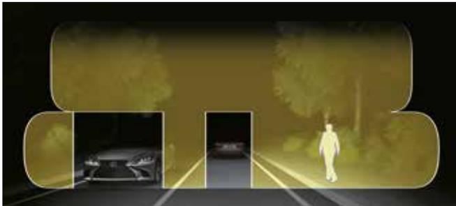
bewährten adaptiven Fernlicht-Assistenten möglich wurde. Dadurch kann das Fahrzeug deutlich länger mit eingeschaltetem Fernlicht gefahren werden, ohne Gefahr zu laufen, den vorausfahrenden oder entgegenkommenden Verkehr zu blenden. Für den Fahrer bedeutet das bessere Sicht bei Dunkelheit- und Nachtfahrten.
