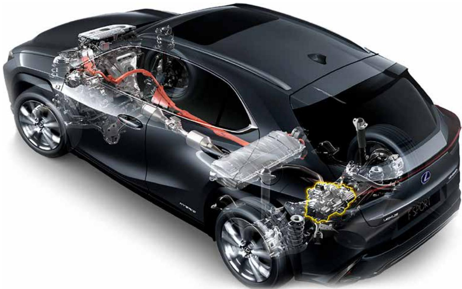
La nouvelle boîte-pont abandonne le montage en ligne des moteurs électriques (MG1 et MG2) au profit d'une configuration coaxiale, plus compacte et plus légère, qui réduit de 25 % les pertes de friction. En outre, le MG2 est désormais un moteur à plus haute vitesse pour une performance et un rendement en hausse. Le conducteur profite ainsi d'un rayon de braquage trottoir à trottoir inférieur de 10,4 m, au meilleur de la catégorie, au bénéfice d'une maniabilité exceptionnelle.
